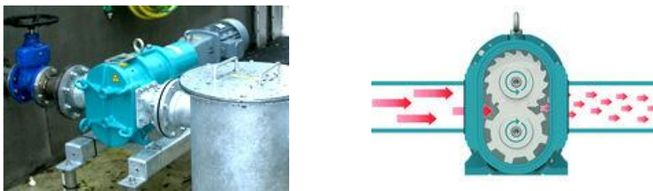
Рисунок 1 – Внешний вид и принцип действия измельчителя Multicrusher Børgger
