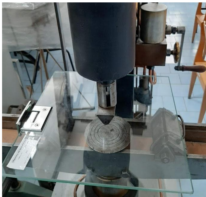
Рисунок 2 - Испытания стеклянного образца на изгиб
