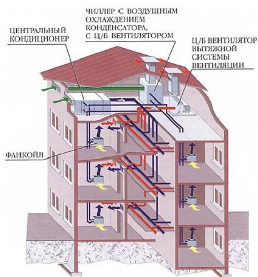
Рисунок 1 - Схема вентиляции в гостинице
