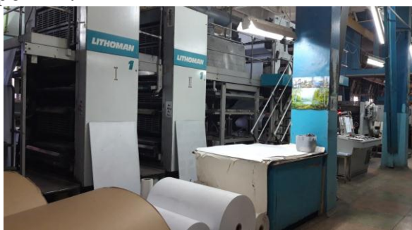
Рисунок 1 - Производственная линия с однокрасочными машинами Lithoman III
